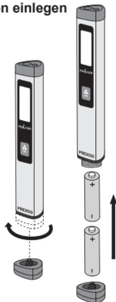
Wechseln Sie die Batterien, wenn das Batteriesymbol blinkt
